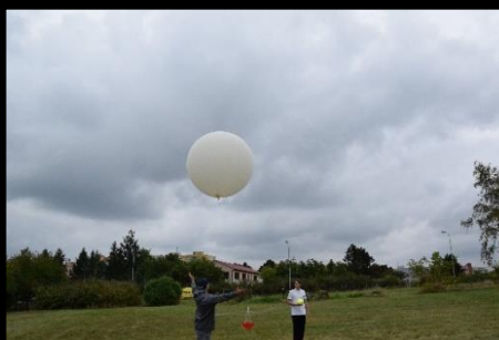
Obrázek 4 - Sondu do nebe vynesl balón plněný héliem.
